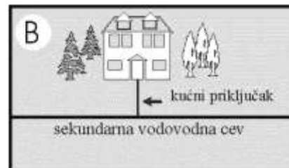
Slika 4. Primarni i sekundarni objekti i kućni priključak
